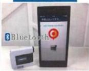
本体とiOSまたはAndroid携帯端末と接続する携帯端末の指示に従い本体側で息をBLOWする
